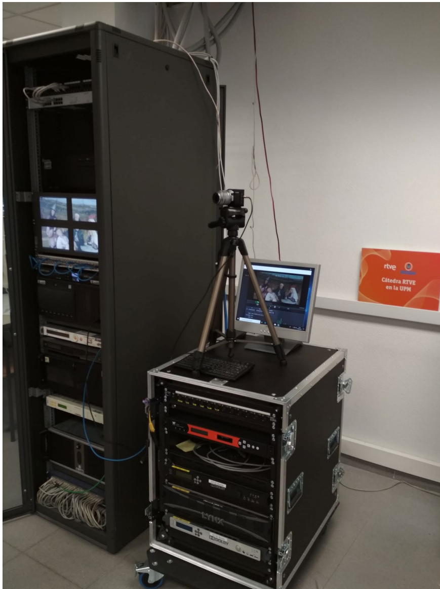
Figura 7. Cabecera de TV del GATV empleada para la emisión de contenidos audiovisuales.
