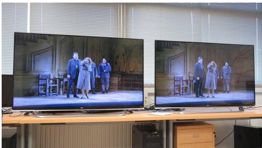
Figura 3. GATV visualizando la señal recibida en DVB-S2 y la señal transmitida en DVB-T2
