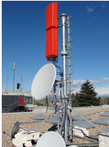
Figura 25. Sistema radiante empleado en las pruebas de emisión de DVB-T2 de la Cátedra
